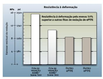
Dados de resistência à deformação baseados na EN13555 usando fita com 15 mm x 3 mm moldada em um anel desbastado com 150 mm. Os valores  $P_{QR}$ foram obtidos com um estresse inicial da vedação de 30 MPa a 150 °C.
