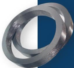
A eficiência dos anéis de grafite se dá pela inserção de lâminas de inox expandido e pelas propriedades físicas especiais do grafite, que **permitem seu uso em temperaturas de -40°C a 400°C**, sendo adequado para choques térmicos e mudança de vapor / condensado.
